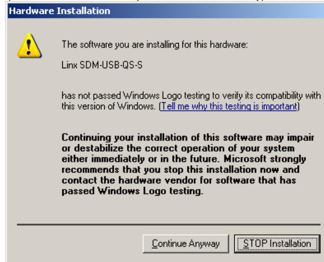
Dieses Fenster ist einfach nur eine Warnung dass der Treiber nicht den Zertifizierungsprozess von Microsoft absolviert hat und möglicherweise ein problem für das System erzeugen könnte. Der mit dem USB-Modul ausgelieferte Treiber wurde unabhängig getestet und sollte keinerlei Probleme auslösen, solange er nicht vom Nutzer modifiziert wird. Klicken Sie auf „Trotzdem fortfahren“
